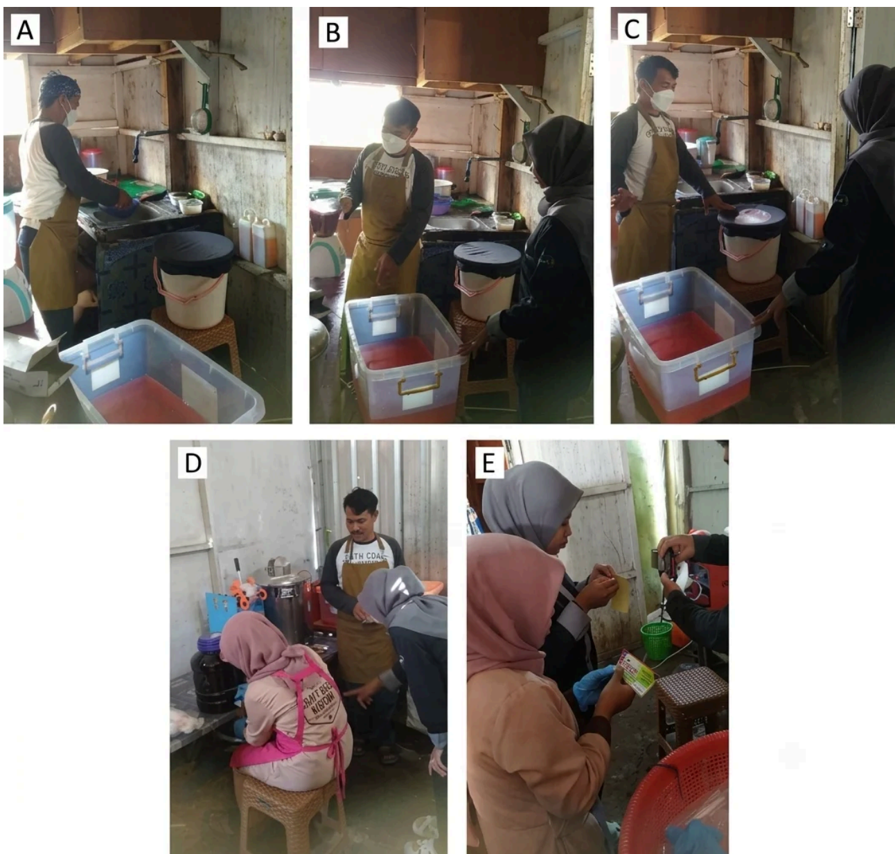
Gambar 2. Tahapan pembuatan sirup buah parijoto: (A) Proses pencucian buah parijoto, (B) Proses penghalusan buah parijoto menggunakan blender, (C) Proses penyaringan sari buah parijoto, (D) Proses pengemasan sirup parijoto, dan (E) Penempelan label produk sirup parijoto.
